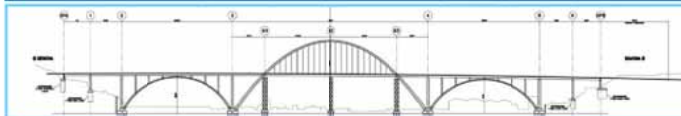
Soluzione 4 Struttura ad archi
